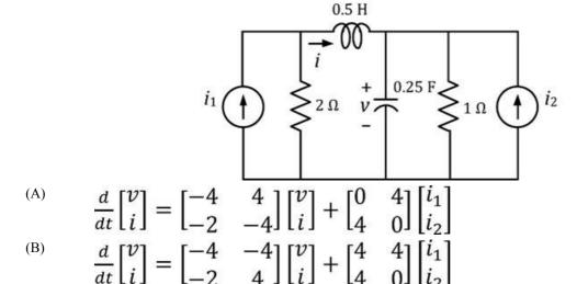
$$\frac{d}{dt} \begin{bmatrix} v \\ i \end{bmatrix} = \begin{bmatrix} 4 & -4 \\ -2 & -4 \end{bmatrix} \begin{bmatrix} v \\ i \end{bmatrix} + \begin{bmatrix} 0 & 4 \\ 4 & 4 \end{bmatrix} \begin{bmatrix} i_1 \\ i_2 \end{bmatrix}
